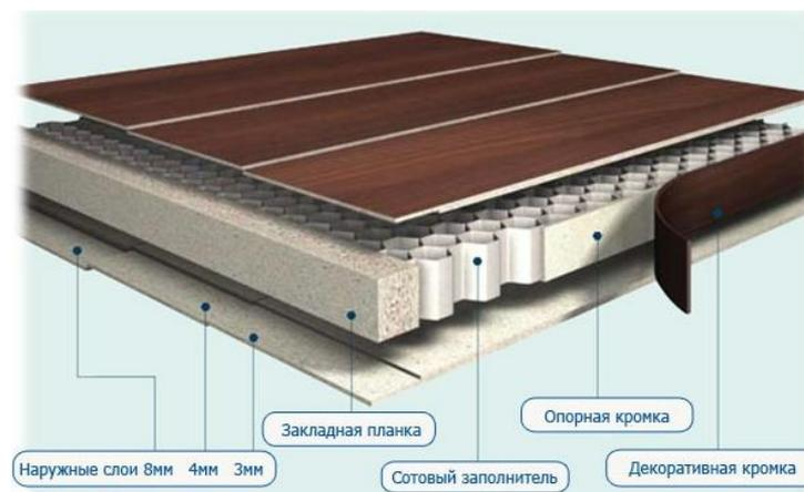
Тамбурат является уникальным композитным материалом. Он состоит из двух внешних слоев (из ДВП, МДФ или фанеры) и слоя сотового наполнителя между ними.
